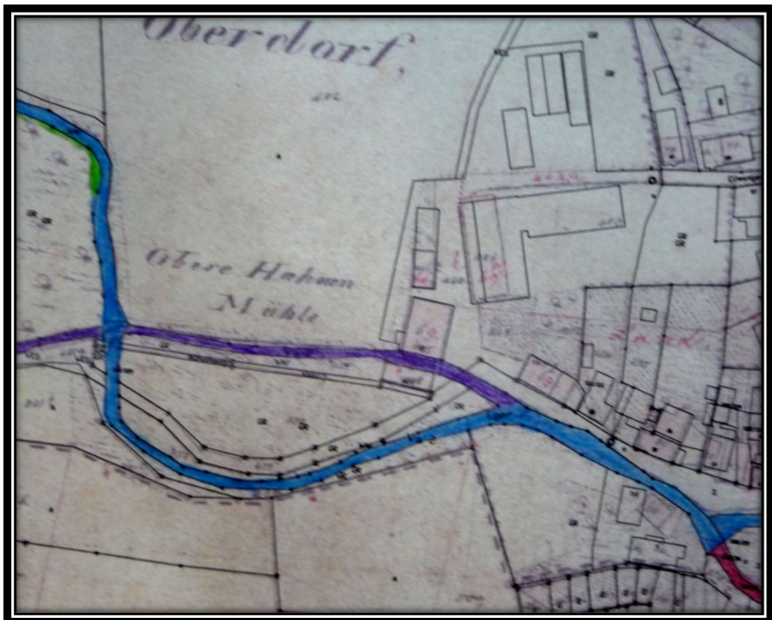
Katasterblatt: Die Obere Hahnenmühle oder Götzenmühle liegt am (violetten) Mühlkanal, der zwischen Getreidemühle und Säge, die noch steht, hindurchfließt.
